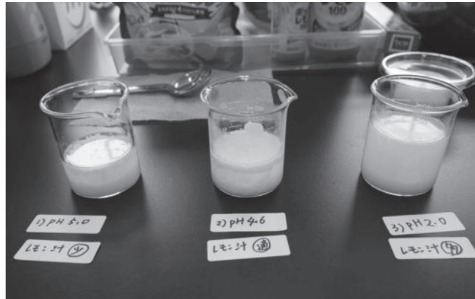
写真5 スキムミルク溶液中のたんぱく質の等電点沈殿
